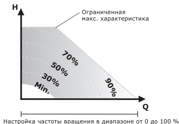
Рис. 60 Ограничения по мощности и давлению, влияющие на максимальную характеристику
